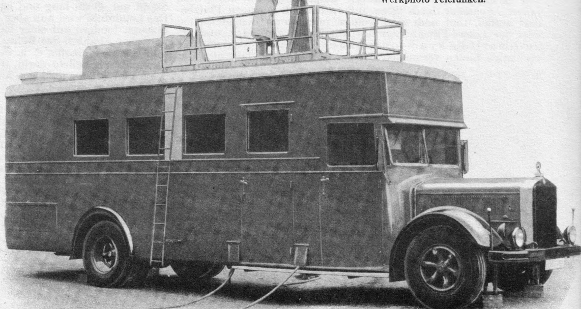
Das Auge der modernen Menschheit: Der Bildfänger. Unscheinbar äußerlich, steht er wie ein Photoapparat auf einem Chassis, besitzt eine Optik und kann nach jeder Seite geschwenkt und gedreht werden. Das wegführende Kabel, das bereits das in elektrische Ströme umgeformte Bild enthält, besitzt nur einen Durchmesser von 35 mm. Werkphoto Telefunken.
